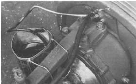
AFB. 76 ONTLUCHTEN VAN DE WIELREMSCILINDER
